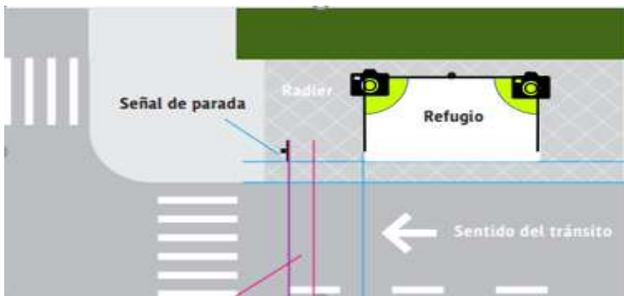
Ilustración 11 Ubicación cámaras en parada con refugio. Elaboración Propia
