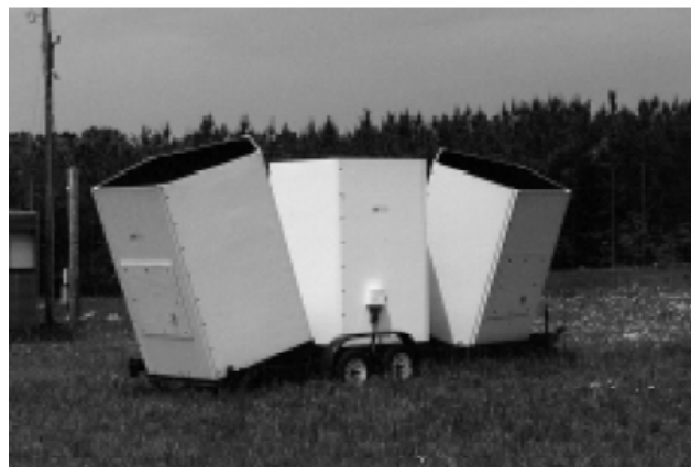
Figura 2.2: Imagen de un SODAR monoestático en donde se puede observar que posee tres transductores. Uno está orientado verticalmente y mide el viento vertical, mientras que los otros dos emiten/reciben en un ángulo de 30 grados (Scintec, 2013) con respecto a la vertical para lograr obtener las tres componentes del viento.
