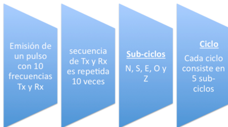
Figura 2.6: Esquema de secuencia de medición típica del equipo SODAR Scintec MFAS.
