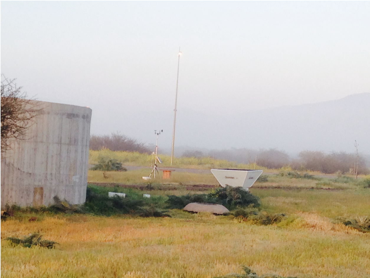
Figura 3.3: Imagen donde se muestra la instalación de la estación meteorológica en superficie y el SODAR
