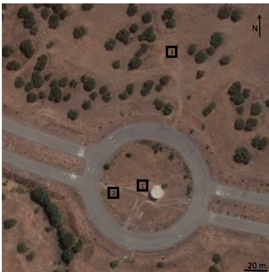
Figura 3.2: Distribución de los equipos instalados. Con el número 1 se señala la ubicación del SODAR, con el número 2 la estación meteorológica en superficie y con el número 3 el punto de izaje del globo cautivo.
