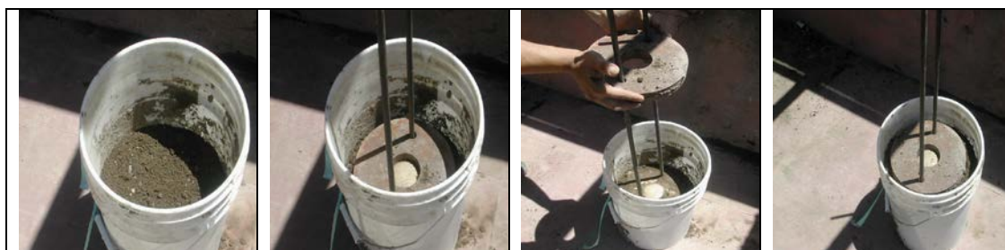
Figura 1. Secuencia de pre compactación con sistema de discos.
