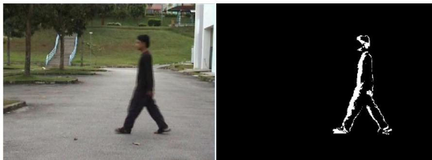
Figura 2.5: Segmentación de persona en movimiento, usando frame difference . A la izquierda, una de las imágenes de entrada. A la derecha, la máscara que identifica la persona en movimiento. [21]
