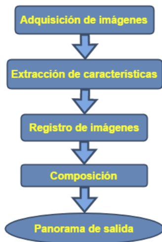
Figura 2.2: Etapas de algoritmos de stitching basados en features .
