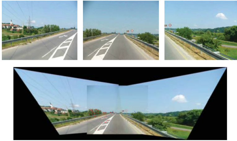
Figura 2.8: Ejemplo de resultado obtenido al aplicar transformaciones de homografía globales para la alineación de imágenes [43].
