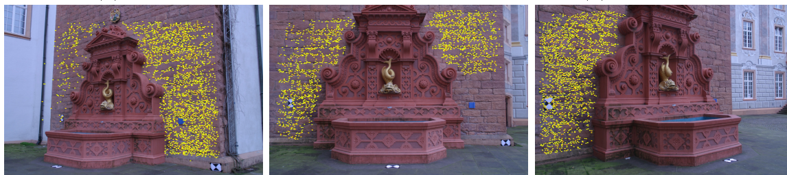
(c) Imágenes representativas con puntos de interés correspondientes a los calces validados por la homografía con la imagen siguiente.
