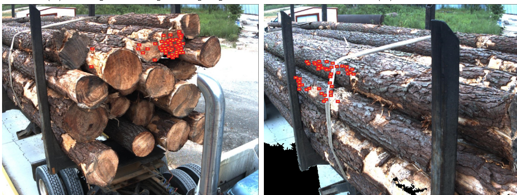
(c) Imágenes representativas con puntos de interés correspondientes a los calces validados por la homografía con la imagen siguiente.
