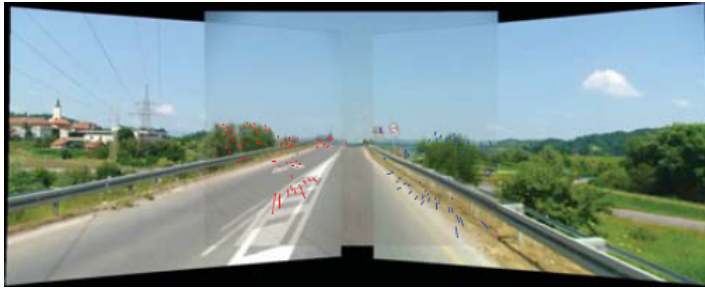
Figura 2.11: Ejemplo de resultado obtenido al aplicar transformaciones euclidianas de rotación para la alineación de imágenes [43].
