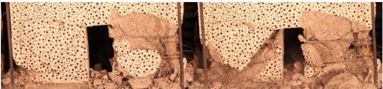
FIGURA 5.27: GRIETA DE CORTE, MR1 (ANTES Y DESPUÉS).
