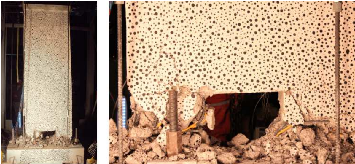
FIGURA 5.15: ESTADO FINAL DEL MURO MR2 AL FINAL DEL ENSAYO (ZOOM A LA DERECHA).
