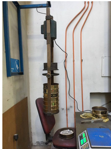
Figura 3.13: Estación de tamizado.
