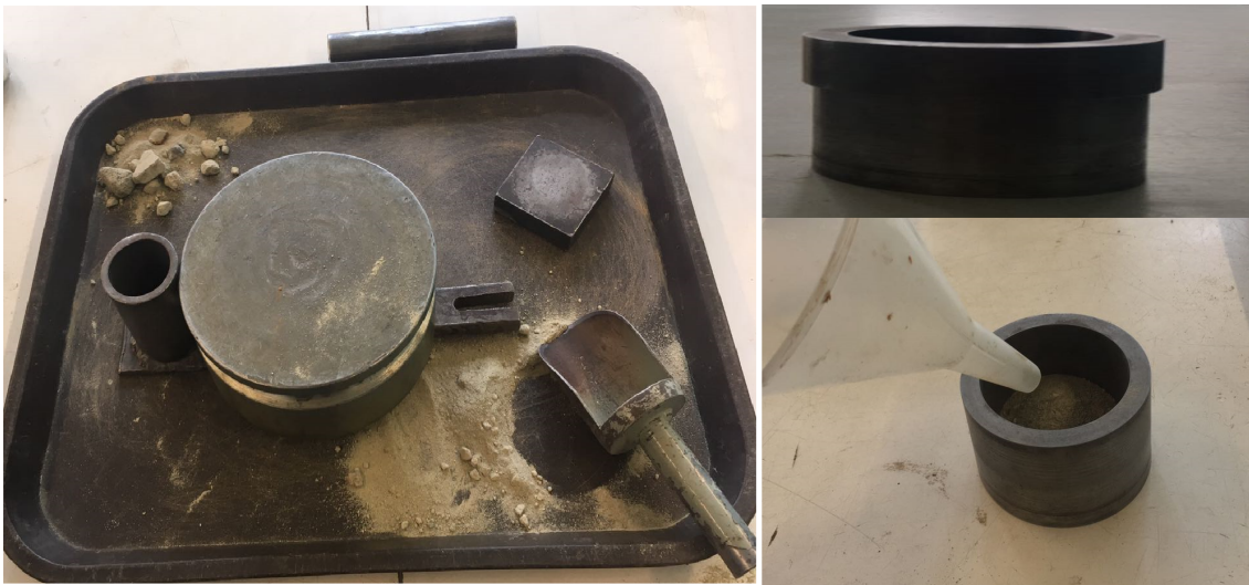
Figura 3.19: Cilindros e instrumentación método japonés (Izq.) y densidad mínima (der.).
