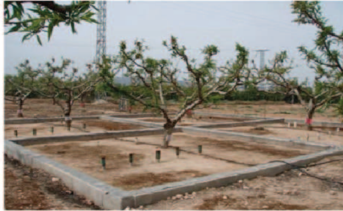
Figura 1. Lisímetro de drenaje en duraznero (Abrisqueta, 2010).
