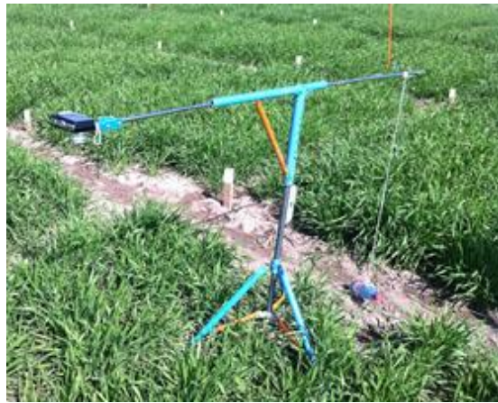
Figura 2. Trípode utilizado para la captura de imágenes fotográficas. Imagen de la izquierda, trípode en campo. Imagen de la derecha, Esquema del trípode utilizado (a: Tornillo para insertar cámara, b: Extensor horizontal, c: Ajuste de inclinación, d: Extensor vertical, e: Contrapeso).
