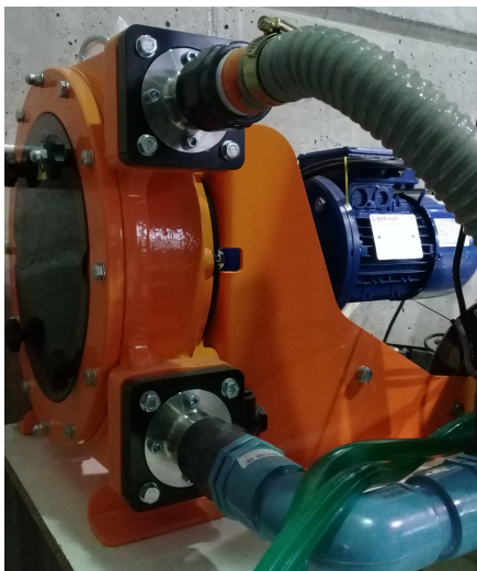
Figura 3.7: Bomba peristáltica y motor
