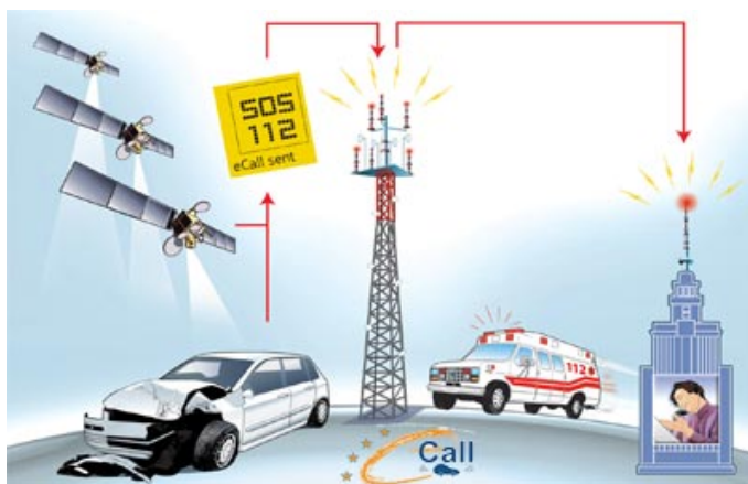
Figura 2.12: Esquema del sistema e-call implementado en Europa. Fuente: [ https://ec.europa.eu/transport/themes/its/road/action_plan/ecall_en ]
