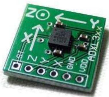
Figura 2.7: Acelerómetro ADXL3. Fuente: [ https://www.ecured.cu/Acelerómetro ]
