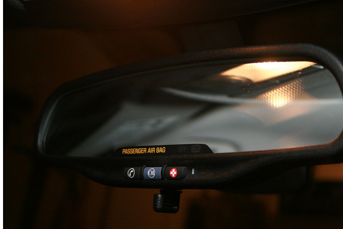
Figura 2.13: Tecnología OnStar integrada en un vehículo Chevrolet. Fuente: [ http://www.chevroletuniversidad.com/OnStar.php ]
