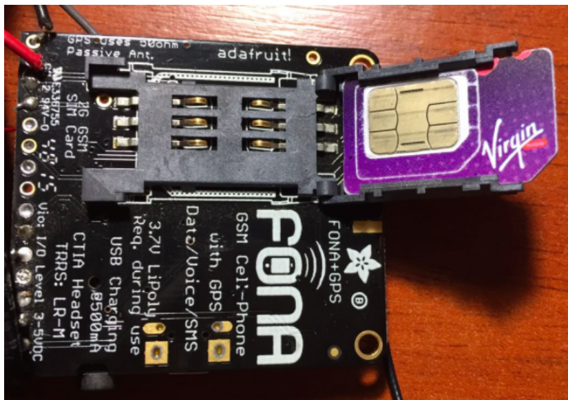
Figura 5.4: Vista trasera FONA 2G con una mini SIM card Virgin Mobile en el slot.
