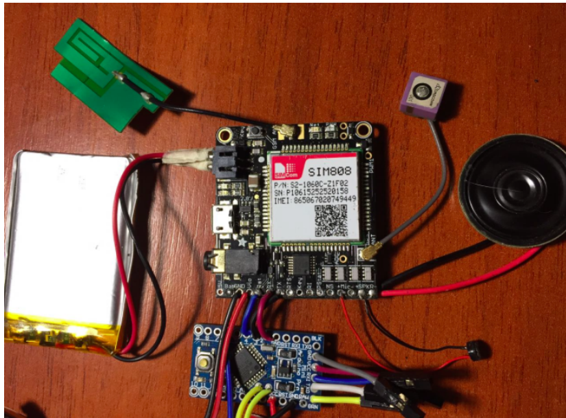
Figura 5.3: Conexión de componentes con el módulo FONA 2G: Arduino Pro Mini, batería, parlante, micrófono, antena celular y GPS
