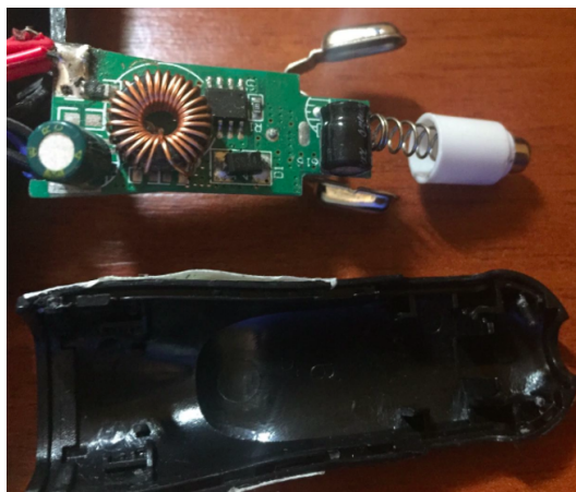
Figura 4.5: Circuito electrónico de un plug-in de cigarrera. Entrada de 12V y salida de 5V.
