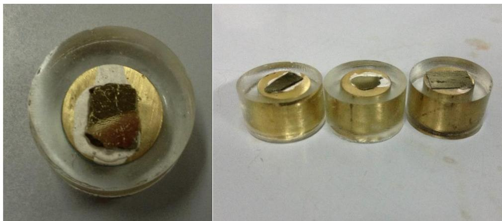
**Figura 4.1** Electrodo de calcopirita construidos para realizar los experimentos.
