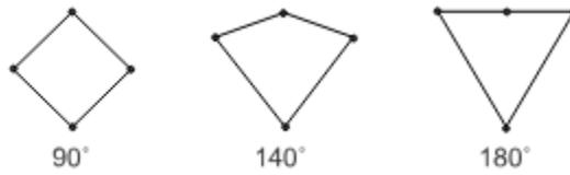
Figura 4.11: Máximos ángulos de esquina para cuadriláteros (ANSYS Reference).
