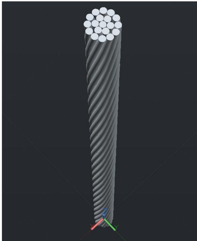
Figura 4.14: Geometría de un cable generada en AutoCAD.
