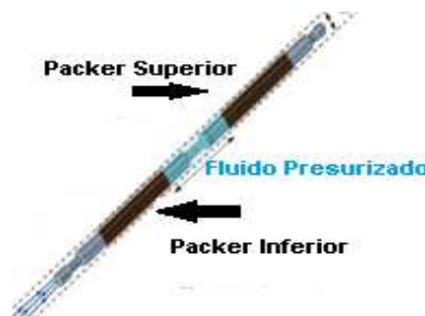
Ilustración 24 Dispositivo de Hidro-fracturamiento (Codelco, 2010)
