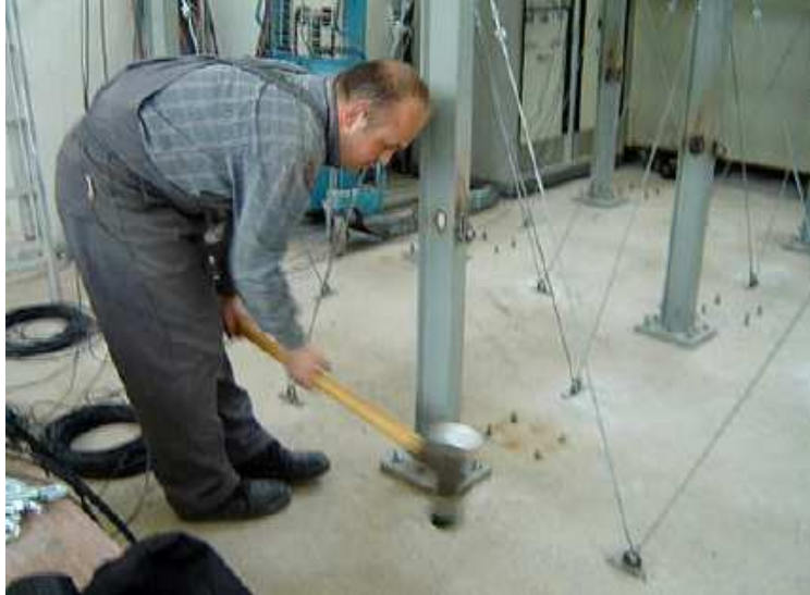
Figura 3.39: Inducción de vibraciones mediante un martillo de impacto (Fuente: Turker, 2011).
