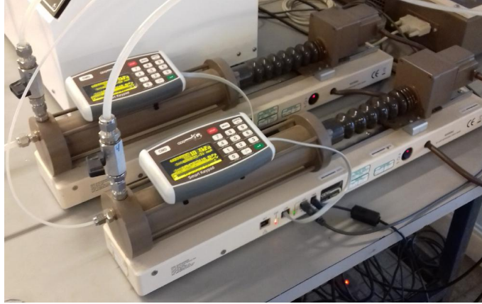
Figura 3.12: Pistones controladores de presión y volumen de agua.
