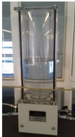
Figura 3.5: Desaireador de agua GDS Instruments
