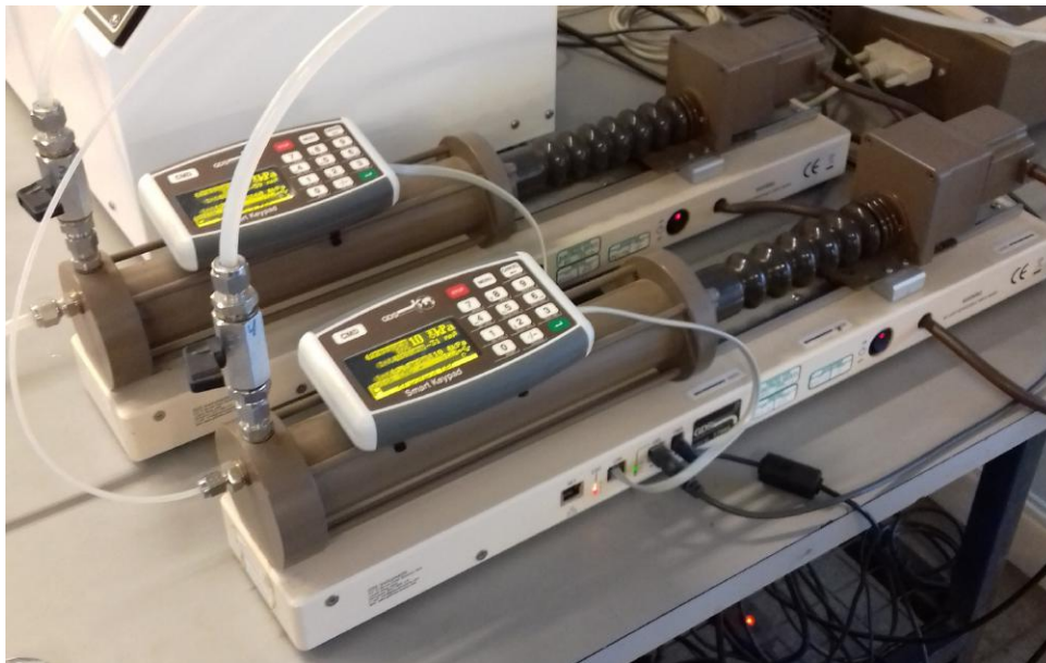
Figura 3.3: Pistones controladores de presión y volumen de agua.
