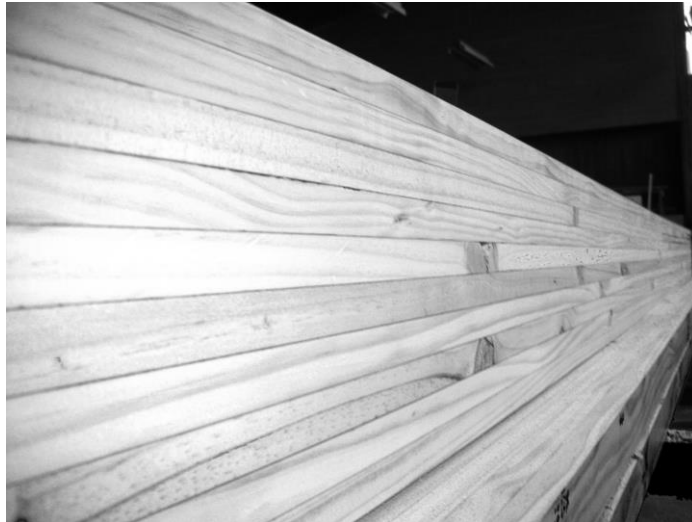
Figura 7: Viga laminada terminada
