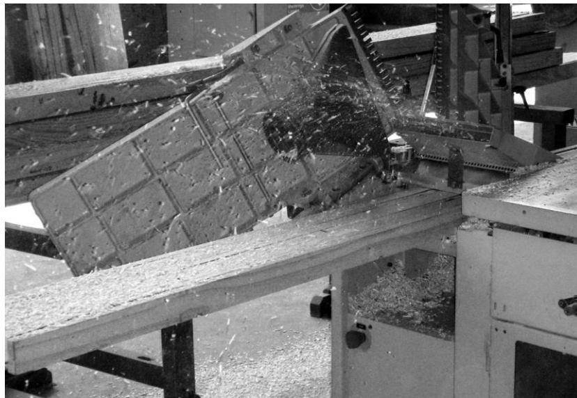
Figura 6: Cepillado de las líneas de cola de una viga laminada
