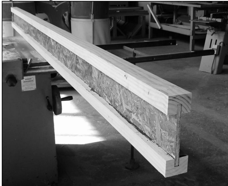
Figura 10: Viga I terminada
