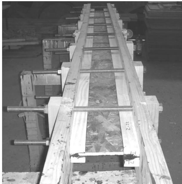
Figura 9: Viga I durante proceso de prensado
