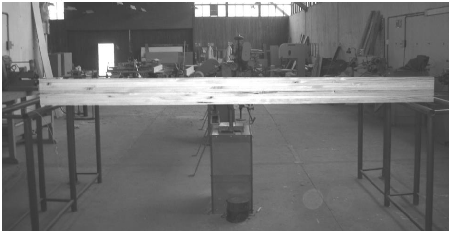
Figura 11: Disposición de una viga laminada para el ensayo de determinación de MOE_V
