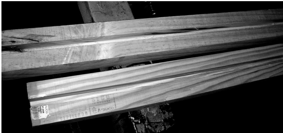
Figura 8: Alas de una viga I
