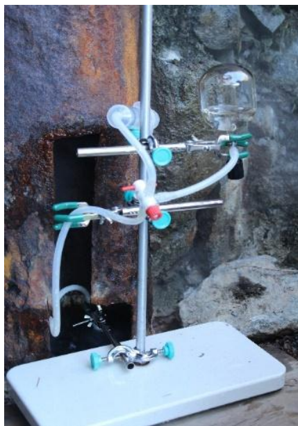
Figura 2.1 Configuración del equipo de muestreo de fuentes termales burbujeantes
