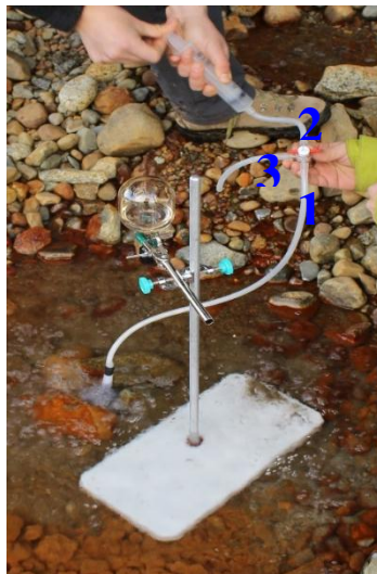
Figura 2.2 Configuración y procedimiento de purga del sistema de muestreo. Conexiones 1, 2 y 3 de la llave de tres vías en azul.
