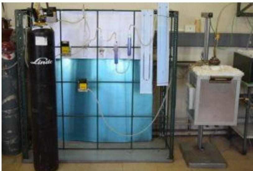
Figura 56. Arreglo experimental, se distingue el tren de gases al centro de la imagen más el horno eléctrico.
