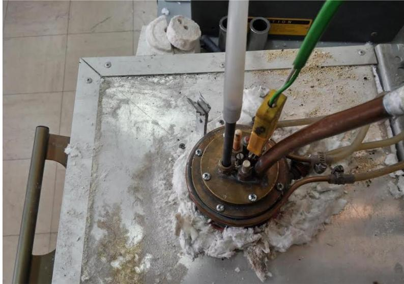
*Figura 58 Tapa superior del horno eléctrico con las disposiciones espaciales de las 3 vaina de alúmina.*
