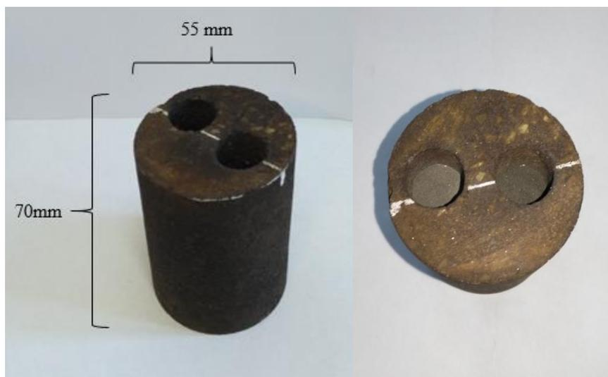
Figura 55. Dimensiones del Crisol de ladrillo refractario. Las perforaciones son de diámetro 16 mm y largo 60 mm. A la derecha, crisol cargado con dos arreglos distintos.
