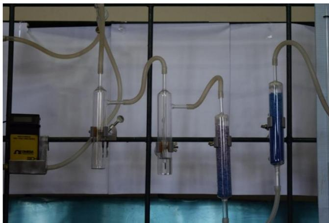
Figura 59. Tren de gases del arreglo experimental. Se distinguen de izquierda a derecha el Flujómetro másico, burbujeador, sílice gel.
