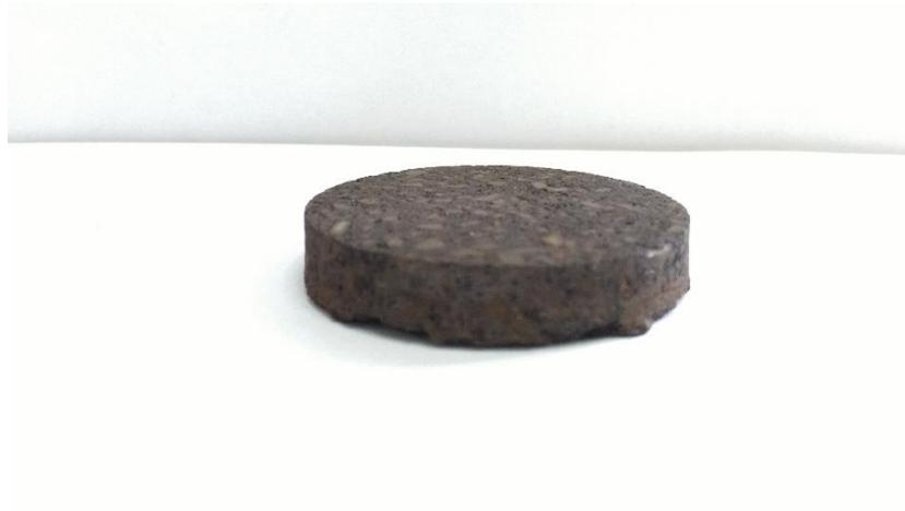
Figura 60. Muestra seleccionada para el cálculo de densidad aparente.
