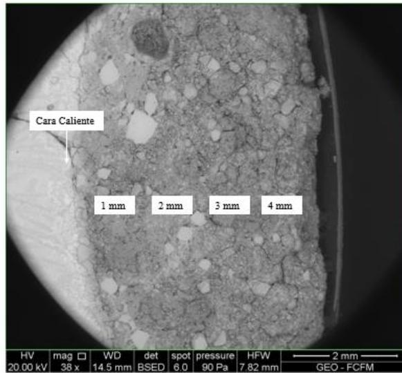
Figura 93. Sección derecha de la muestra. Cuantificación por medio de EDS desde la cara caliente a la zona interior del ladrillo.
