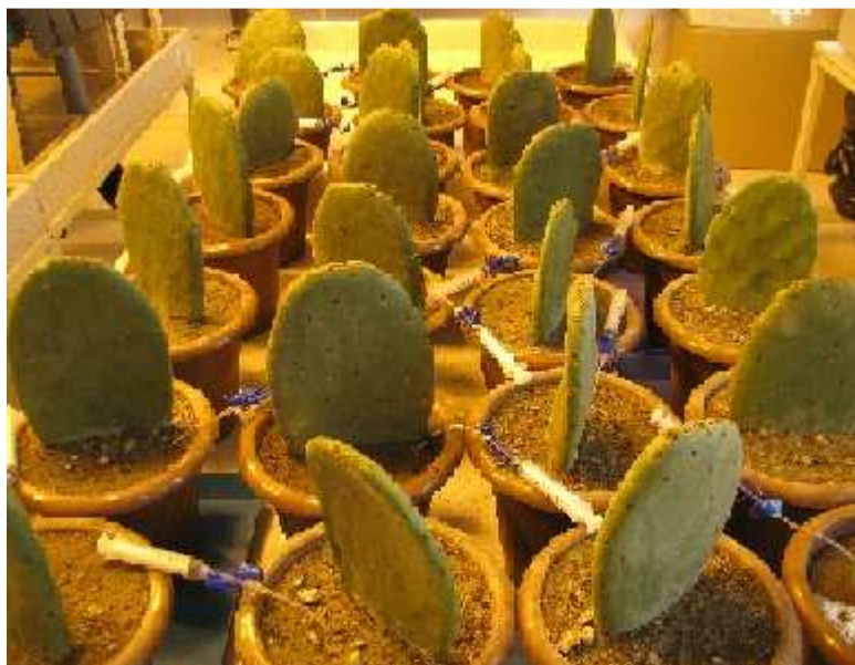
Figura 4: Macetas experimentales con jeringas instaladas para la extracción de agua de poro con muestreadores Rhizon® soil pore water samplers insertados en los sustratos.
