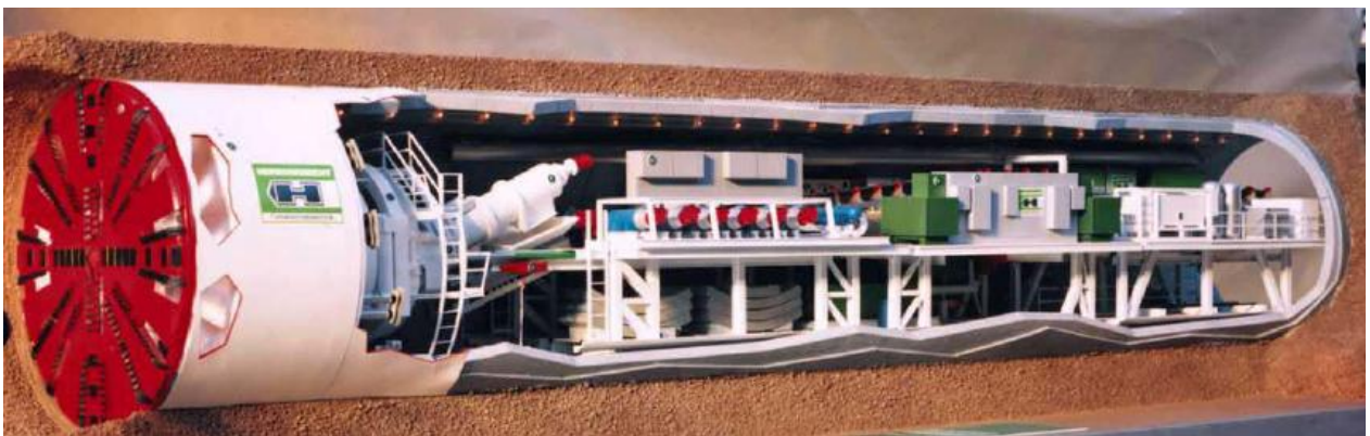
Figura 2-18. Maqueta de una Escudo EPB.
