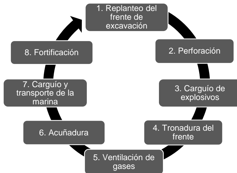
Figura 2-8. Esquema del proceso constructivo en base al método de Perforación y Tronadura.
