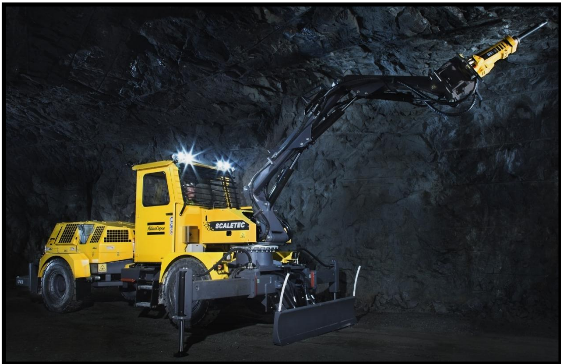
Figura 2-11. Equipo Scaletec UV2, útil para la etapa de acuñadura.
