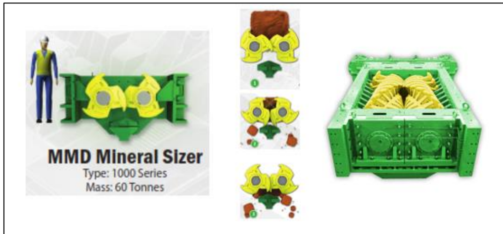
Figura 8.- Chancador de bajo perfil, Sizer. (MMD, 2016)
