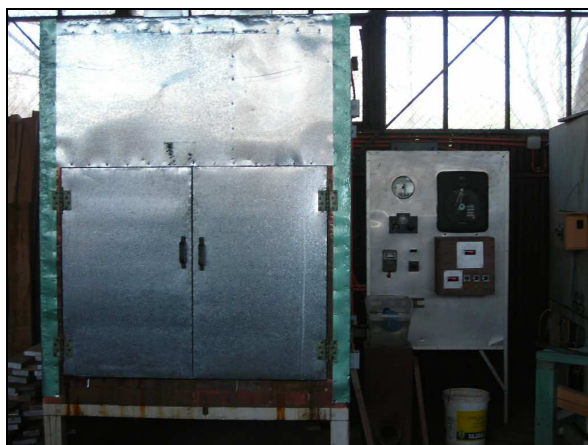
Figura 2.1: Cámara de secado a escala piloto
