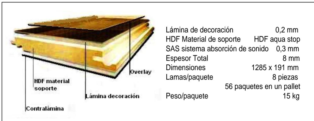
Figura 6: Estructura Pisos Laminados Kronostep.
