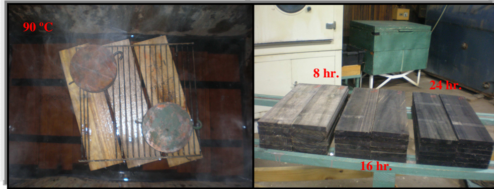
Figura N°10.- Ejemplo de inmersión: secciones sumergidas a 90°C y extraídas de forma aleatoria a los tres diferentes tiempos.
