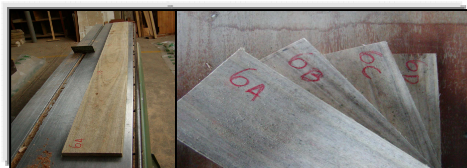
Figura N°9.- Ejemplo de trozado. Tabla “6”. Secciones “6A”, “6B”, “6C” y “6D”.
