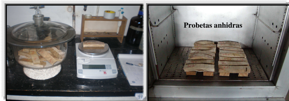
Figura N° 12.- Obtención de CH mediante el método de secado en estufa.
