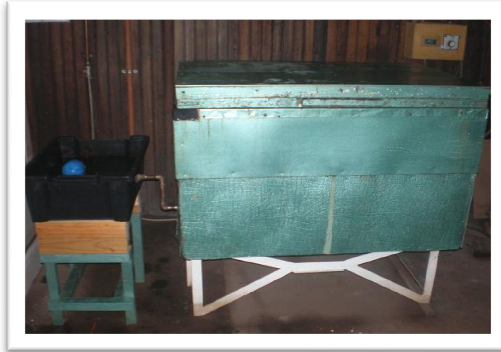
Figura N°4.- Estanque de tratamiento de agua caliente.
