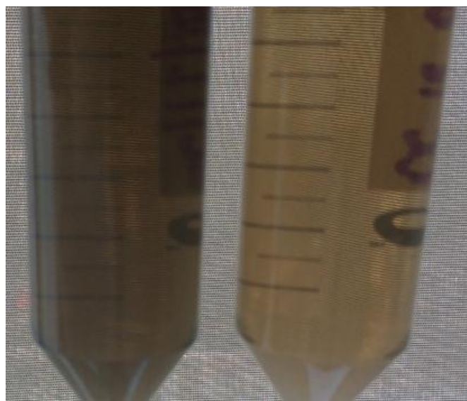
Figura 4.13 nanofluido de GO (izquierda) baja oxidación, (derecha) alta oxidación
