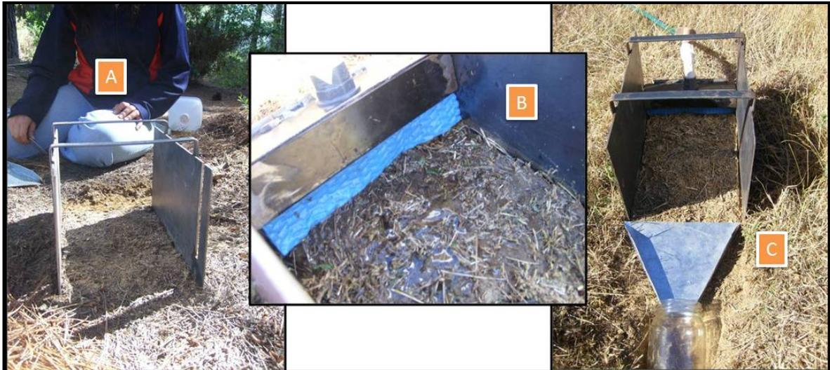
**Figura 7.** Instalación de la parcela de escurrimiento (A) y desarrollo de experimento (B y C).
