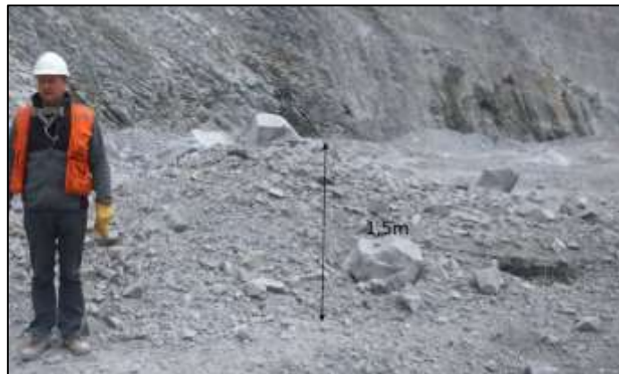
Figura 40 Levantamiento de piso por pre-corte
