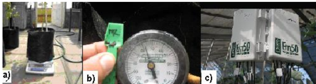
Figura 2. Equipos utilizados en mediciones de suelo, a) variación de peso en macetas (transpiración), b) tensión de Succión, c) data loggers (sensores de humedad).
