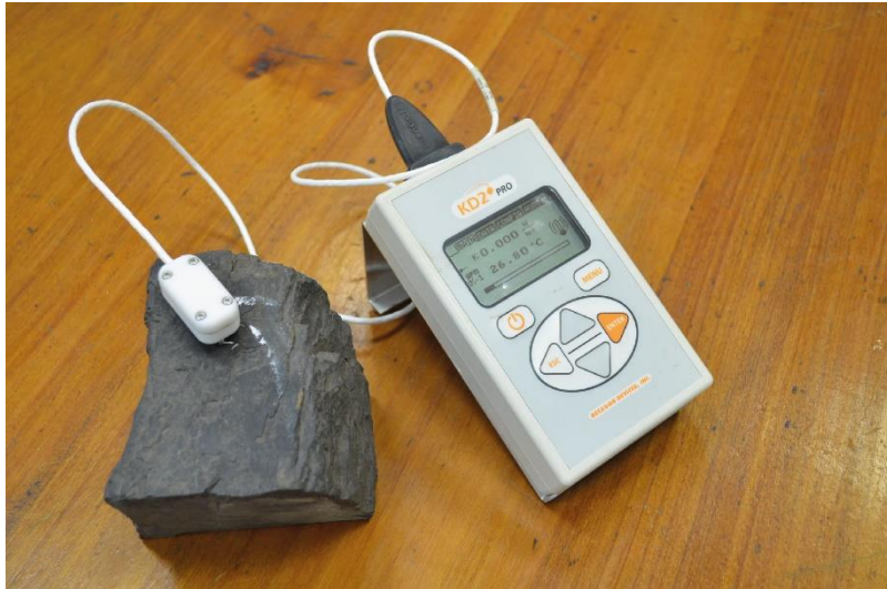
Figura 29. Medición de conductividad térmica con el equipo KD2Pro en el Departamento de Geología de la Universidad de Chile.
