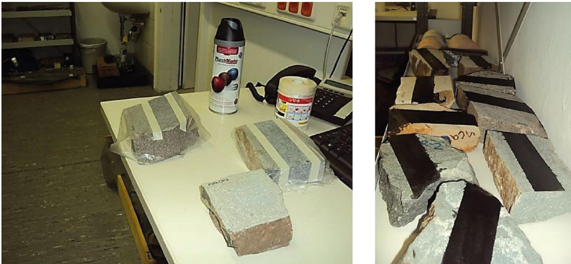
Figura 26. Preparación de muestras para medición de conductividad y difusividad térmica con el Escáner de Conductividad Térmica (TCS).
