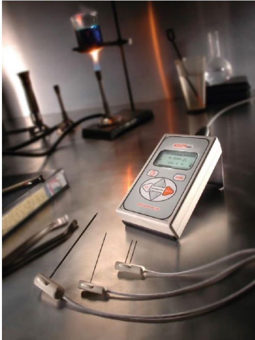
Figura 28. Equipo KD2Pro de Decagon Devices. Izquierda: el equipo de medición con diversas sondas. Derecha: sonda RK1 específica para medir conductividad térmica de rocas.
