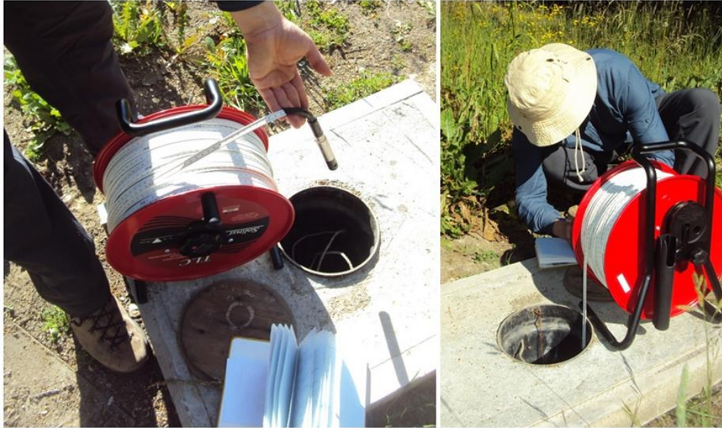
Figura 20. Medición de temperatura y nivel estático en pozos para captar agua subterránea.
