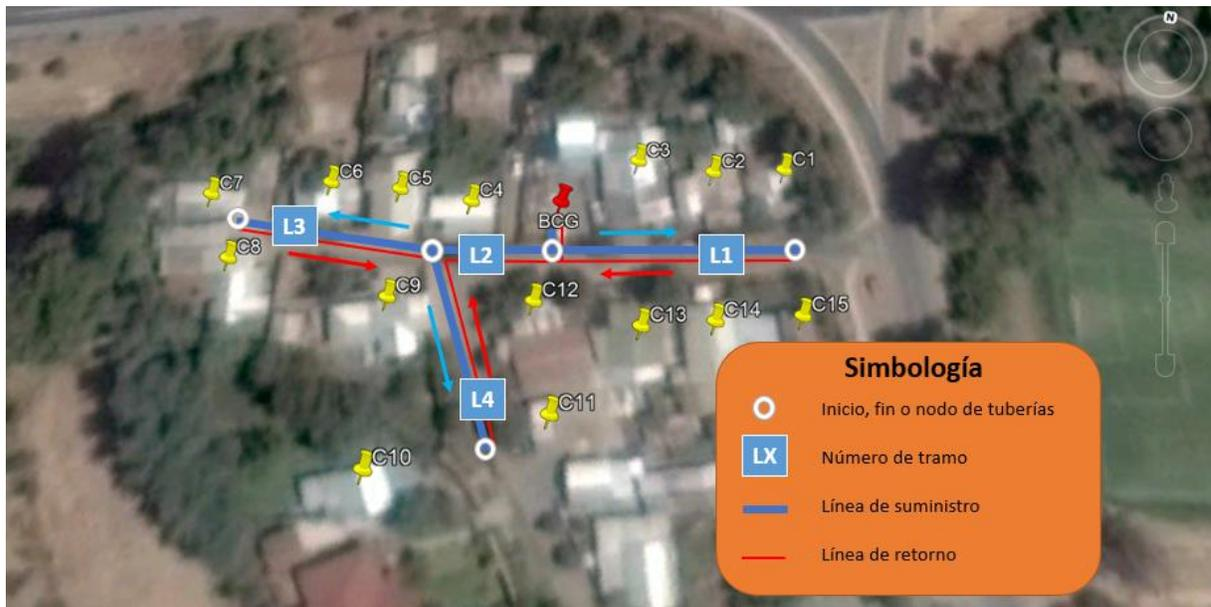
Figura 4-8: Líneas de suministro y retorno del sistema de distribución de agua caliente. Fuente: Elaboración propia.
