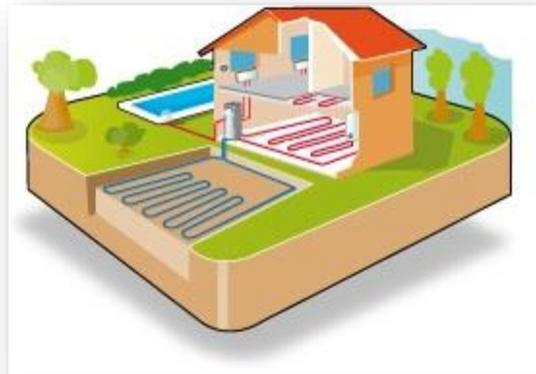
Figura 2-4: Sistema de captación horizontal. Fuente: adaptado de [9].
