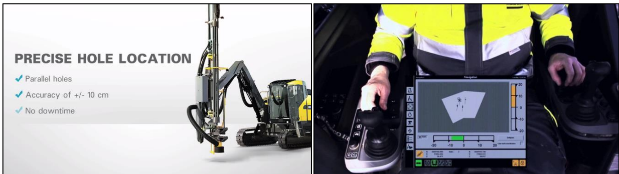
Ilustración 19. Tecnología de navegación, perforadoras SMARTROC D65 de Atlas Copco.
