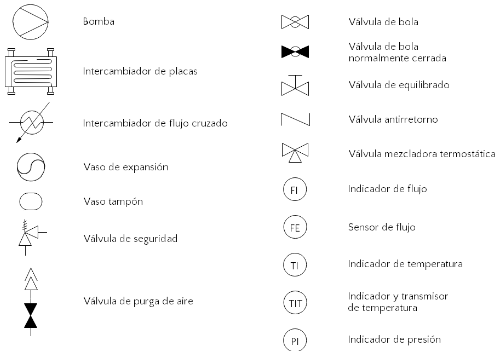
Figura 4.15: Simbología utilizada en el diagrama P&ID.
