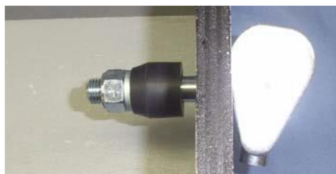
Figura 40: Fijador en posición final con tuerca apretada. (Ref. 10)
