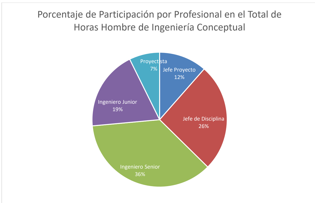
Gráfico 11: Participación por Profesional en el Total de Horas Hombre de la Ingeniería Conceptual.
