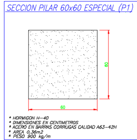
Figura 22. Sección transversal de pilares, ejemplo 1.
