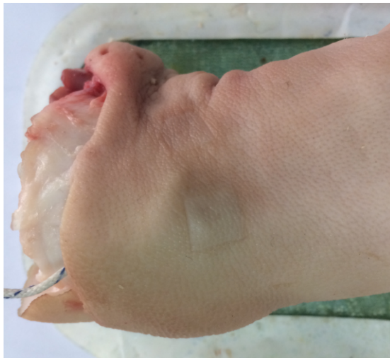
Figura 5.7: Estado final de la piel luego de 8 mediciones experimentales con la combinación Titanio-Tungsteno.
