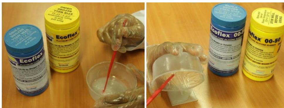
**Figura 31. Proceso de mezcla de las componentes A y B.**
