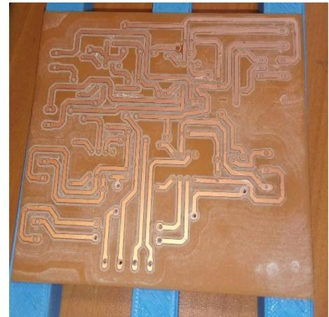
**Figura 45. Prototipo del circuito electrónico de cuatro (04) canales del sistema de amplificación**
