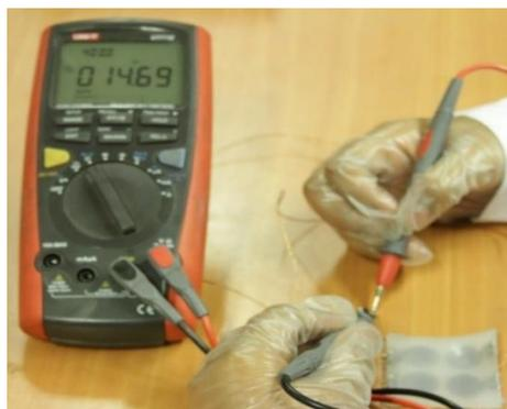
**Figura 38. Verificación de la continuidad entre terminales**
