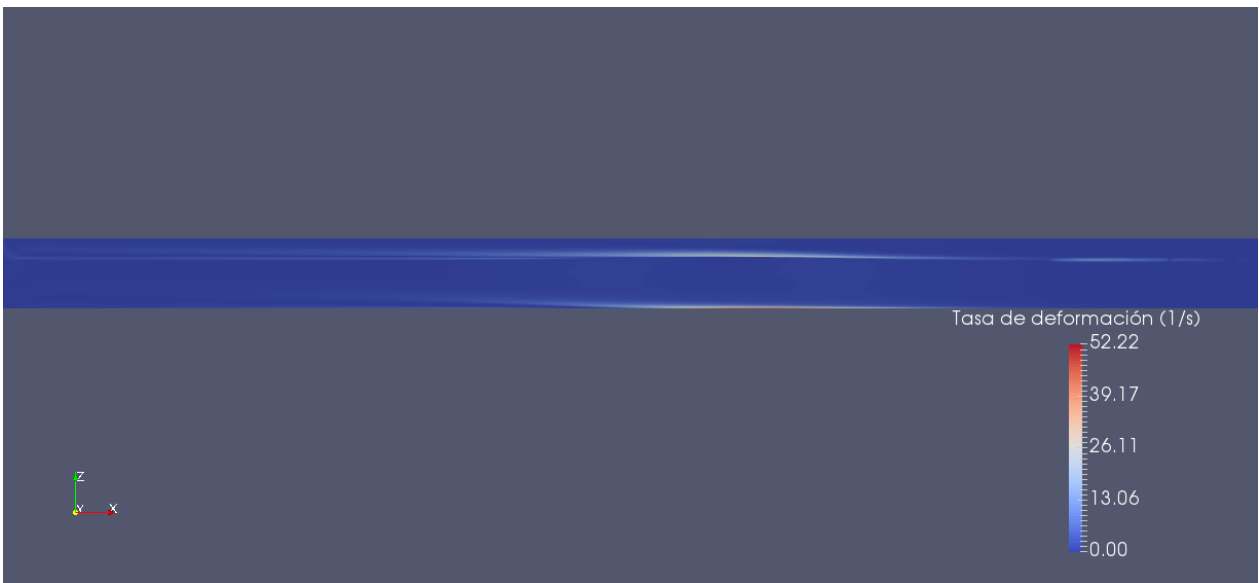
Figura C.6: Tasa de deformación numérica para el modelo pseudoplástico con n=0,8 .
