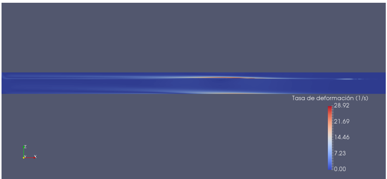
Figura C.9: Tasa de deformación numérica para el modelo pseudoplástico con n=0,6 .
