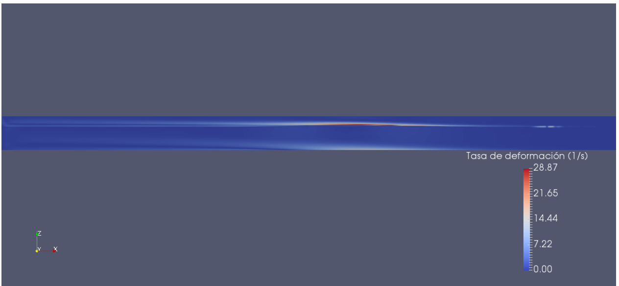
Figura C.3: Tasa de deformación numérica para el fluido newtoniano.
