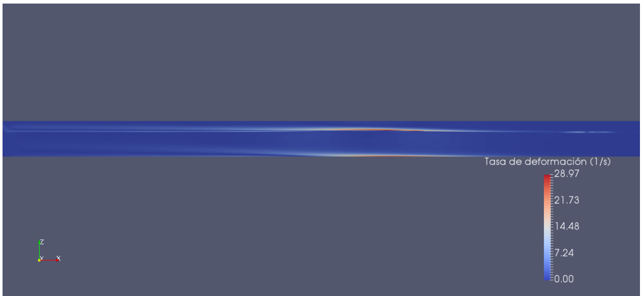
Figura C.12: Tasa de deformación numérica para el modelo pseudoplástico con n=0,4 .
