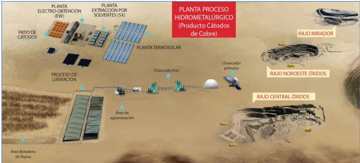
Figura 7: Flow Sheet de la Planta de Hidrometalurgia 4
