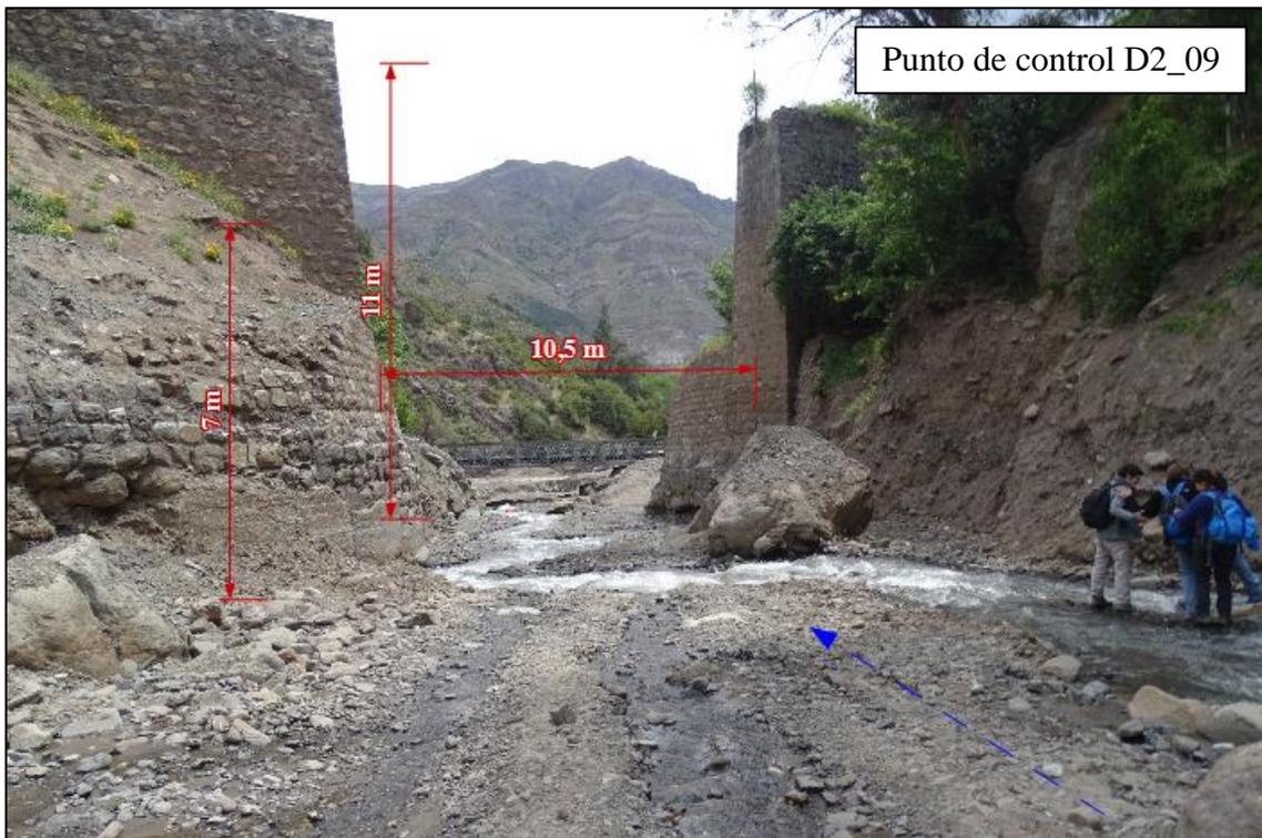
Figura IV.11. Medición en punto D2\_09 de la trayectoria del flujo del 25 de febrero de 2017.
