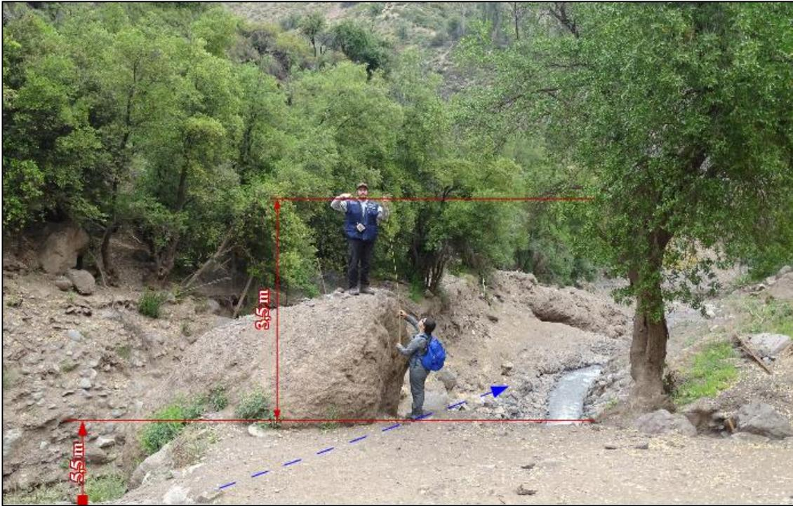
Figura IV.8. Medición en punto D2\_06 de la trayectoria del flujo del 25 de febrero de 2017.
