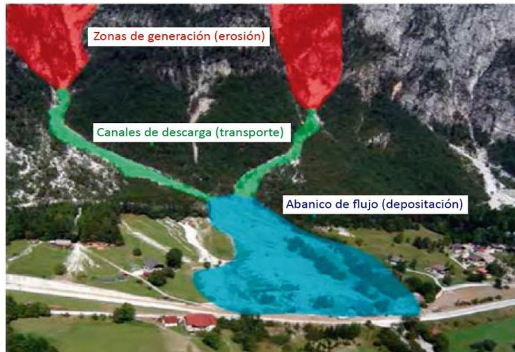
Figura 4.3. Mapeo de la trayectoria de un flujo de detritos. Modificada de Nhuchhen (2017).
