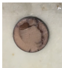
Figura 5.12: Disco de LSGM con grietas.
