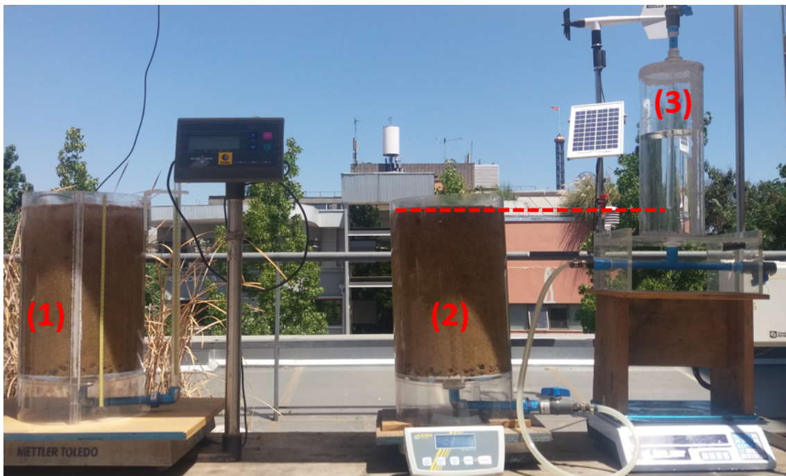
Figura 3.1: Montaje experimental (disposición final). De izquierda a derecha: suelo parcialmente saturado (1), suelo saturado (2) y Frasco de Mariotte (3), que fija el nivel de agua en el estanque de suelo saturado.
