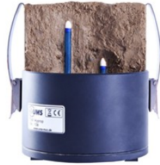
Figura 3.7: Instrumento Hyprop utilizado para la estimación de la curva de retención de humedad del suelo.
