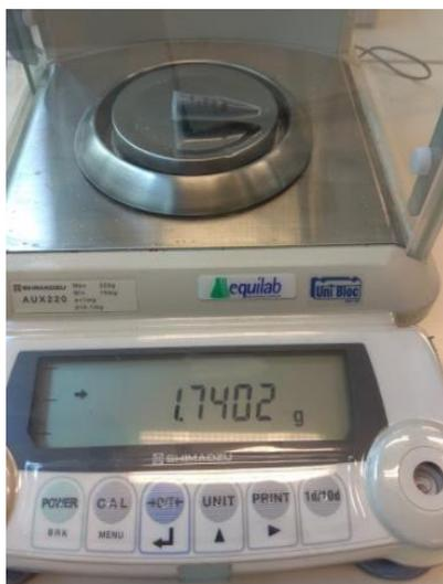
**Figura 3.8 Pesado de polvos a usar para fabricar probetas.**
