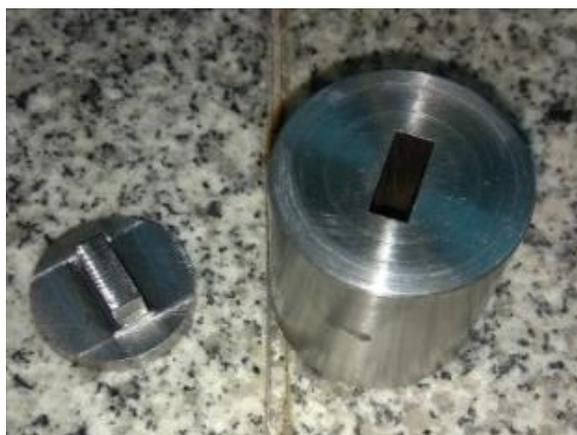
**Figura 3.7 Matriz para fabricación de probetas.**
