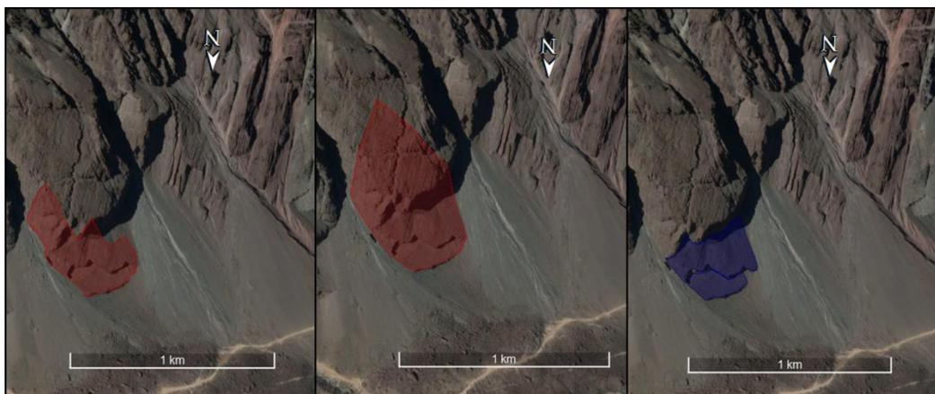
Figura 82: Comparación entre el área deslizada aproximada de acuerdo a los modelo dinámicos. Imagen izquierda: área de deslizamiento mínima. Imagen central área de deslizamiento máxima. Imagen derecha: área de deslizamiento real.
