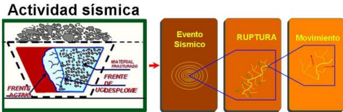
Figura 9 Esquema conceptual de generación de actividad sísmica en minería de Caving [22].
