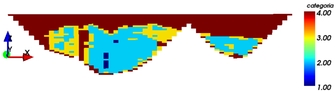
Figura 11.8: Vista del plano X-Z del yacimiento categorizado para el tamaño de bloque de 30 metros.
