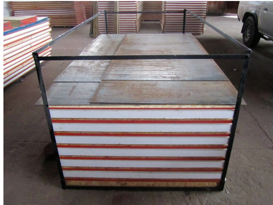
Figura 7d Jaula de armado y prensado con plancha de acero
