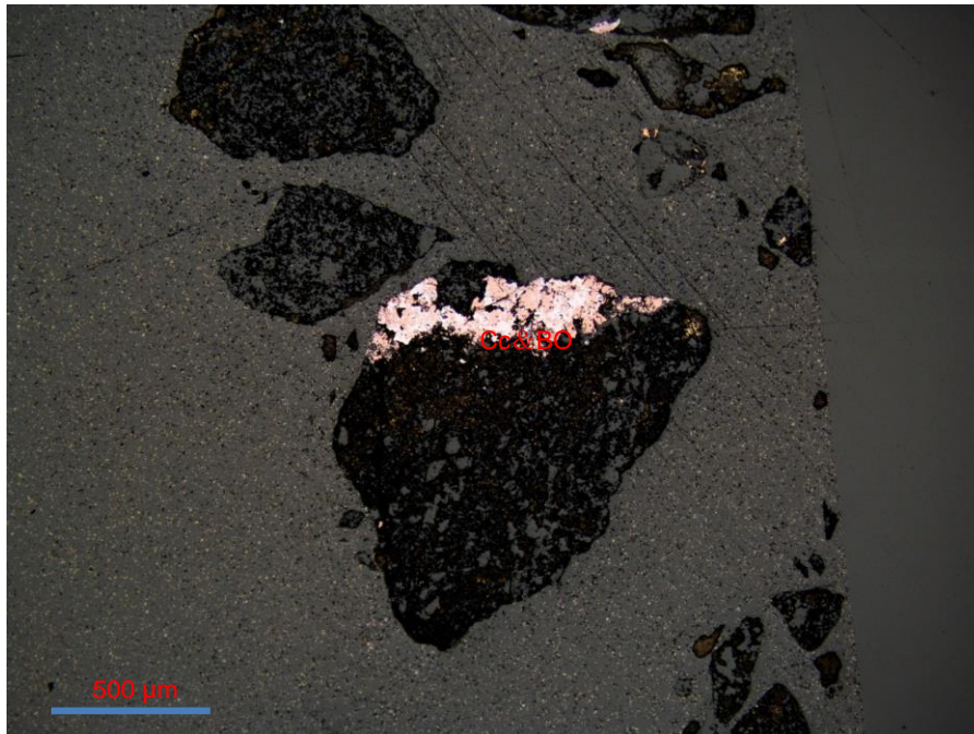
Figura 19 Partículas eutécticas de bornita y calcosina en caliza que incluye rocas ígneas (Bo: bornita, Cc: calcosina)
