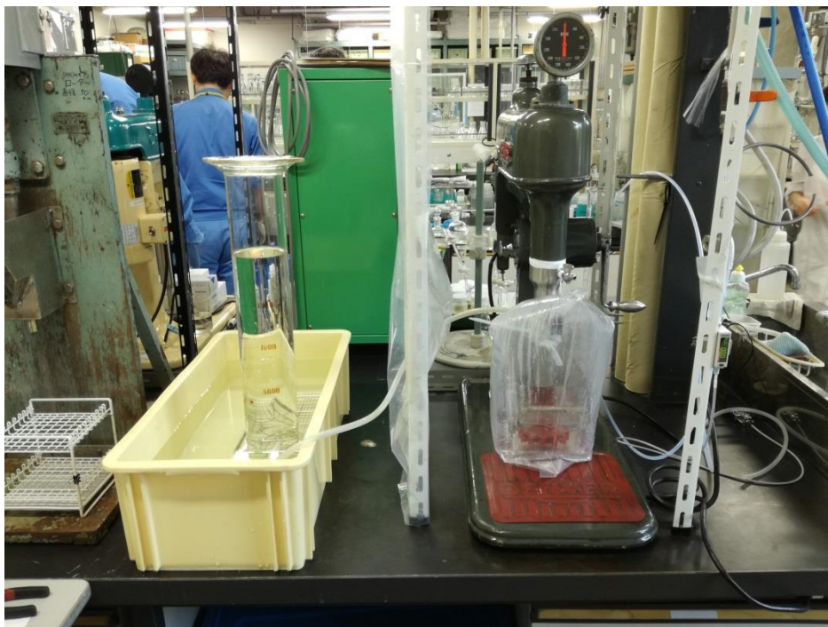
Figura 8 El sistema de medición del flujo con la celda del tipo Denver
