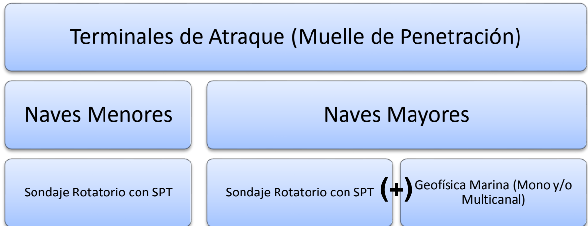
FIGURA 51. DIAGRAMA DE EXPLORACIÓN PARA TERMINALES DE ATRAQUE (MUELLE DE PENETRACIÓN). (FUENTE: DOP, 2013).
