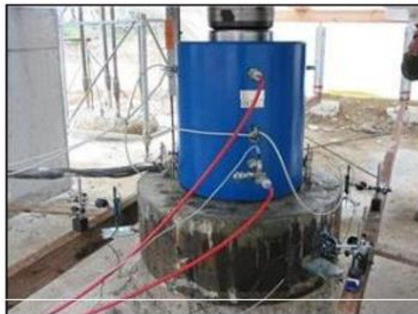
FIGURA 32. ENSAYO DE CARGA EN PILOTES. (FUENTE: CFT & ASOCIADOS. ENSAYOS Y PRUEBAS DE PILOTES, 2012).
