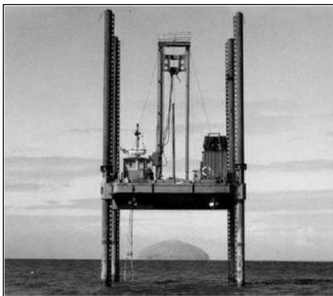
FIGURA 33. PLATAFORMA ELEVABLE TIPO JACK-UP (FUENTE: ISSMGE, 2005).
