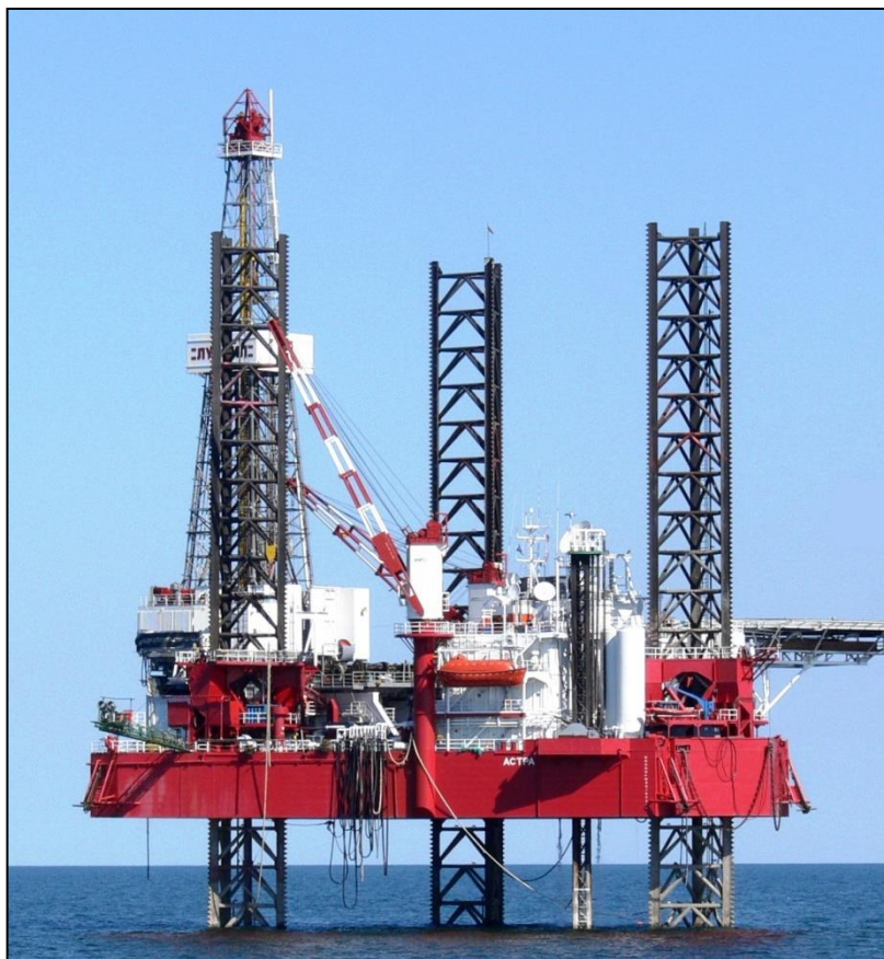
FIGURA 17. PLATAFORMA JACK UP TIPO ASTRA (FUENTE: HTTP://WWW.EURASIADRILLING.COM/OPERATIONS/OFFSHORE/JACK-UP-RIGS/ [CONSULTA 22-11-2017]).
