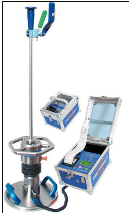
FIGURA 25. HERRAMIENTA UTILIZADA PARA ENSAYO DE PLACA DE CARGA, EN SU VERSIÓN DINÁMICA. (FUENTE: TERRATEST).
