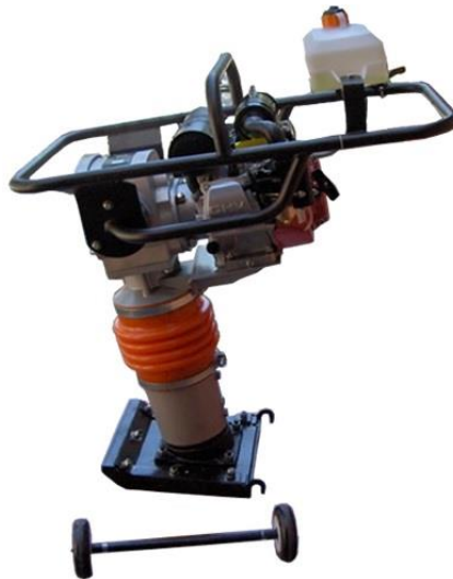
Figura 0-1. Equipo utilizado para la compactación del relleno estructural en la modelación del proceso constructivo
